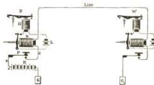
FIG. 99. LOCAL CIRCUIT OF TELEGRAPH SYSTEM.
