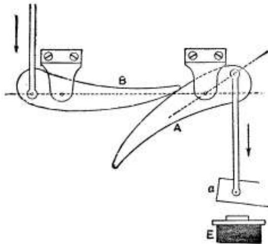
Fig. 167. CAM EQUALIZER.
