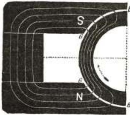
Fig. 221. ONE-HALF PORTION OF A DOUBLE MAGNETIC CIRCUIT.
