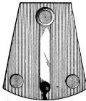
Fig. 309. SIMPLE SWITCH.
