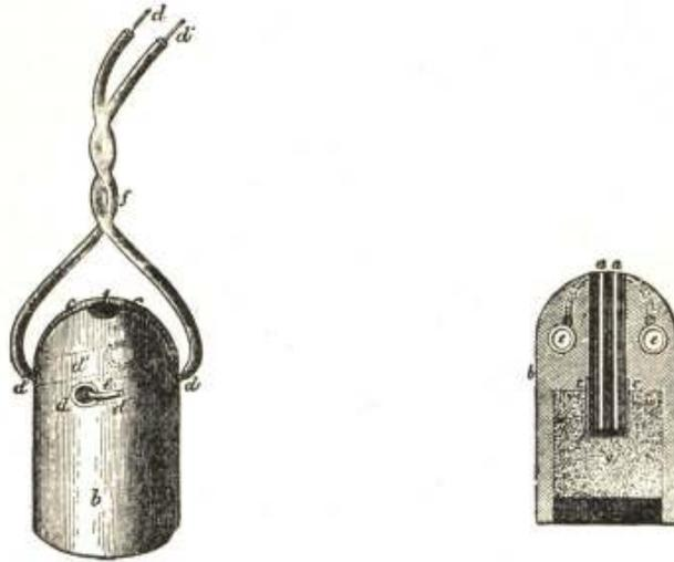
Fig. 177. ELECTRIC FUSE.
