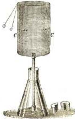
FIG. 300. WIRE GAUZE ELECTRIC SCREEN.
