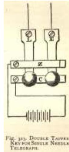
Fig. 323. DOUBLE TAPPER KEY FOR SINGLE NEEDLE TELEGRAPH.
