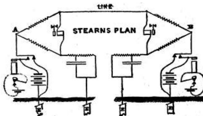
Fig. 313. STEARN'S PLAN OF DUPLEX BRIDGE TELEGRAPHY.
