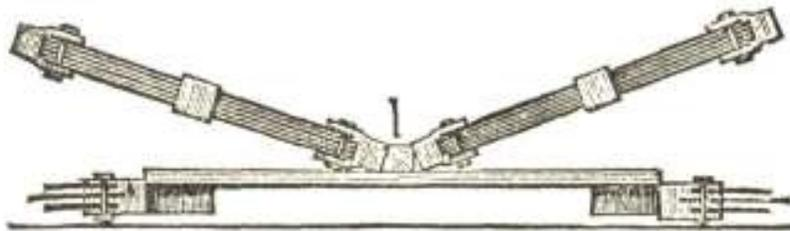
Fig. 228. MAGNETIZATION BY DOUBLE TOUCH.
