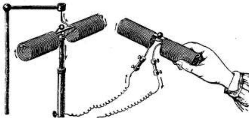
Fig. 305. EXPERIMENTAL SOLENOID.
