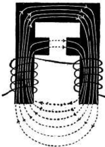
Fig. 225. MAGNETIC SHUNT.
