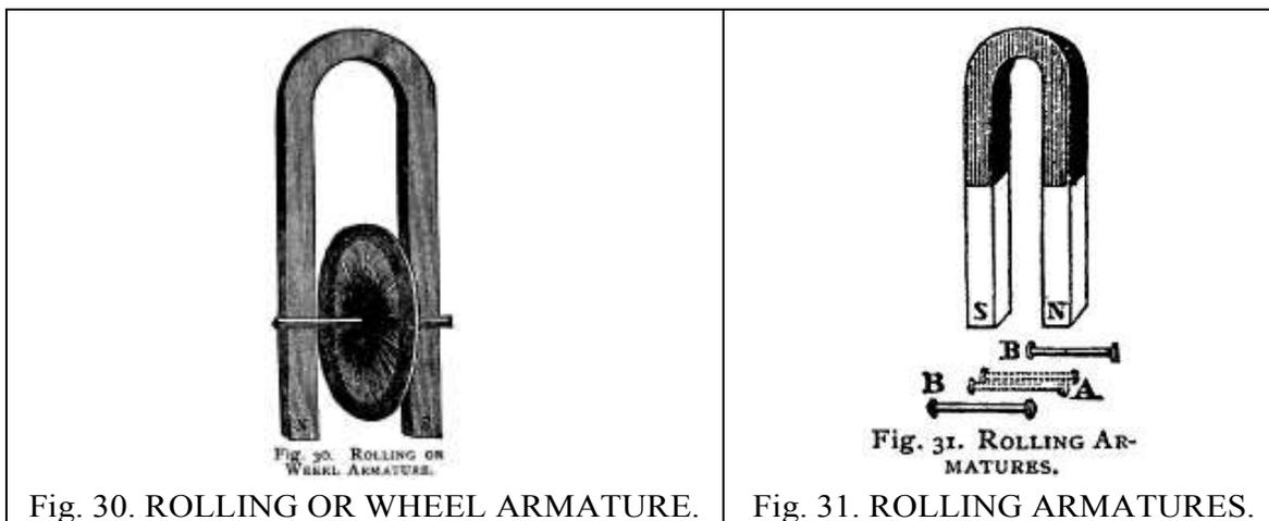
Fig. 30. ROLLING OR WHEEL ARMATURE.
