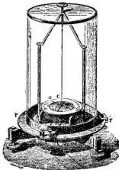
Fig. 186. TORSION GALVANOMETER.
