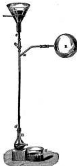
Fig. 277. SPRENGEL AIR PUMP.
