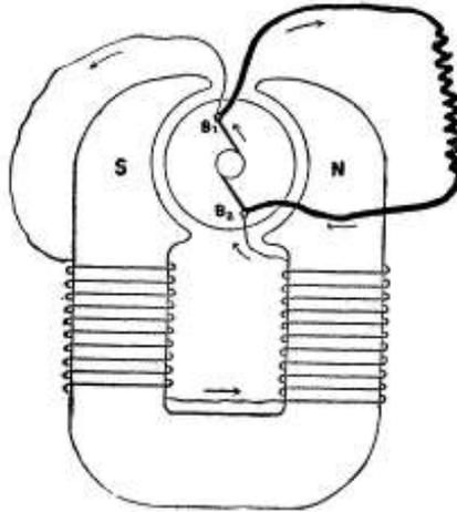
Fig. 141. SHUNT DYNAMO.
