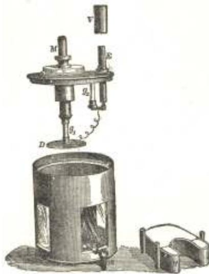
FIG. 154. PORTABLE ELECTROMETER.
