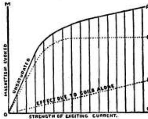
Fig. 124. MAGNETIZATION CURVE.
