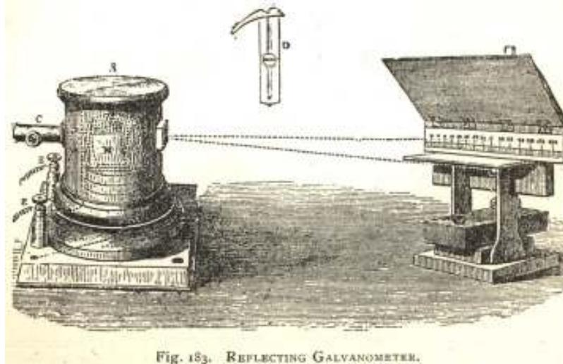
Fig. 183. REFLECTING GALVANOMETER.
