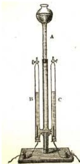
Fig. 341. GAS VOLTAMETER.
