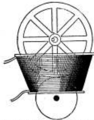
Fig. 190. MAGNETIC FRICTION GEAR.
