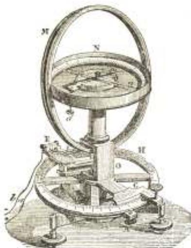
Fig. 184. SINE GALVANOMETER.
