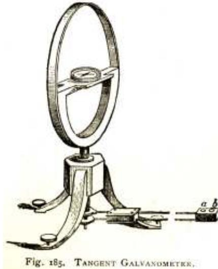
Fig. 185. TANGENT GALVANOMETER.
