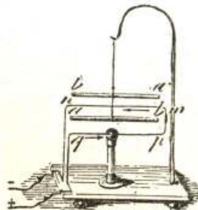
Fig. 178. ASTATIC GALVANOMETER.
