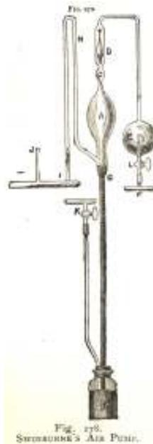
Fig. 278. SWINBURNE'S AIR PUMP.
